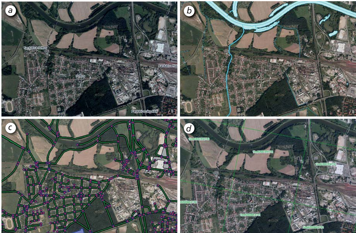
Obr. 66 Publikace prohlížečích služeb INSPIRE a) zeměpisná jména, b) vodstvo, c) dopravní síť, d) zeměpisné soustavy souřadnicových sítí
