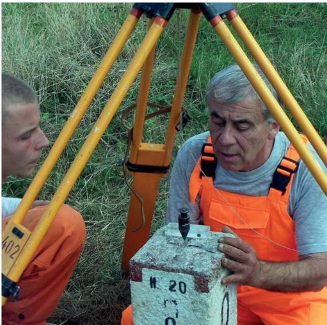
Obr. 22 Stabilizace bodu na státních hranicích
