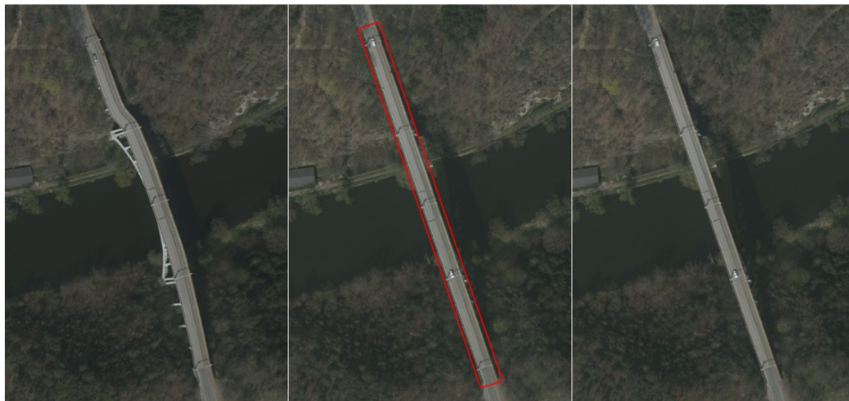
Obr. 7: Vlevo ortogonalizace na DMR 4G, uprostřed 3D mostovka, vpravo ortogonalizace na DMR 4G, který byl doplněn o 3D mostovku
