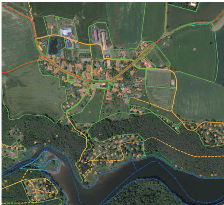
Obr. 4 Superpozice Ortofota ČR s vektorovým obrazem ZABAGED
